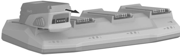
1. Valider le mécanisme de déverrouillage de l'accu.
