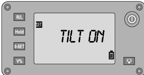
Uključivanje odn. isključivanje kompenzatora
