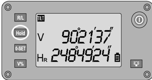
Očitanje horizontalnog kruga se može zadržati pritiskom na tipku **HOLD**, zatim se može postaviti novi cilj te ponovnim pritiskom ponovo pokrenuti očitanje kruga.
