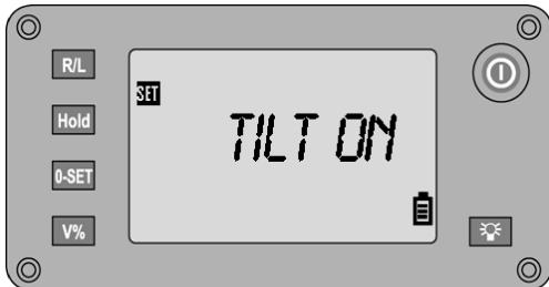
Zapnutí, resp. vypnutí kompenzátoru
