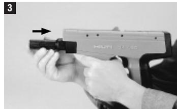
Montare l'anello d'arresto sulla guida chiodo. Infilare la guida chiodo nella guida pistone.
