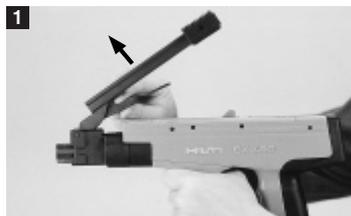
Ruotare la leva di caricamento in avanti. Spingere in avanti la guida nel corpo dell'attrezzo e contemporaneamente tirare verso l'alto la levetta cava fino al suo sganciamento.
