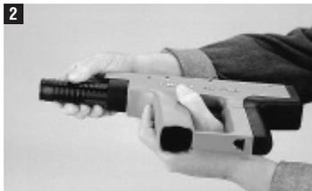
Far scivolare la guida pistone nella carcassa. (Le aperture nella guida pistone devono corrispondere con quelle del silenziatore).
